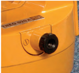
Rys. 4. Widok pionu optycznego ze śrubkami rektyfikacyjnymi w teodolitech Carl Zeiss Jena
