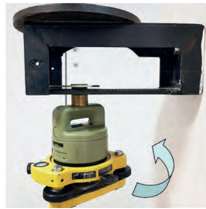
Rys. 5. Mocowanie spodaręki z wbudowanym pionem optycznym
